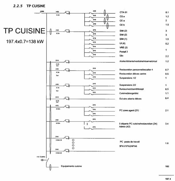
Il sera en outre prévu 8 Compteurs d'énergie électrique : départ CTA01, départ CSa, départ CEa, départ CEb, Alimentations diverses, Alimentations cuisine, départs éclairage, départs PC y compris toutes sujétions (tores, câblage etc.) permettant d'assurer les remontées des informations de comptage dans le ou les automates de la GTB.
