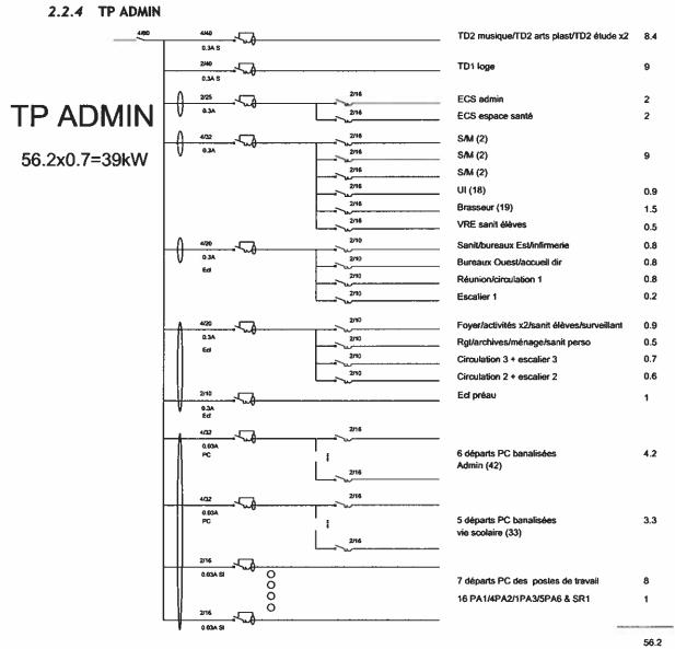
Il sera en outre prévu 5 Compteurs d'énergie électrique :départ ECS, Alimentations diverses, départs éclairage administration, départs éclairage vie scolaire, départs PC y compris toutes sujétions (tores, câblage etc.) permettant d'assurer les remontées des informations de comptage dans le ou les automates de la GTB.
